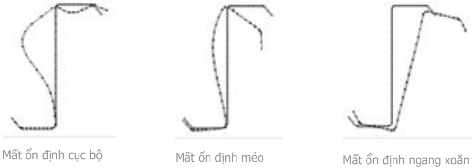
Hình 1. Các dạng mất ổn định của tiết diện chữ Z chịu uốn
