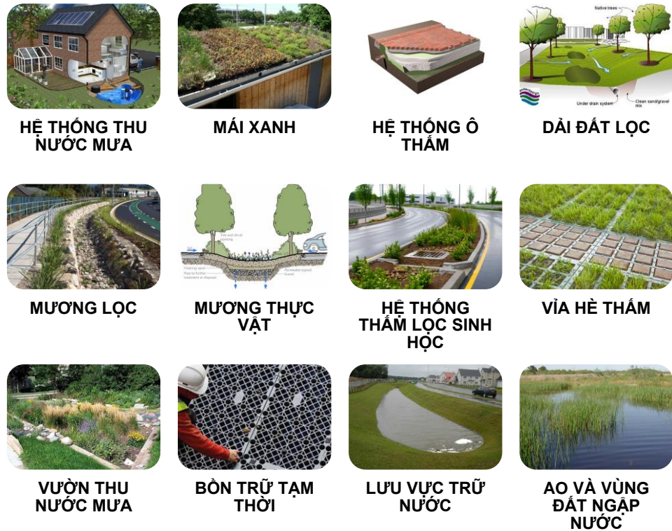
Hình 3.6 Minh họa các giải pháp kỹ thuật thoát nước theo hướng bền vững
