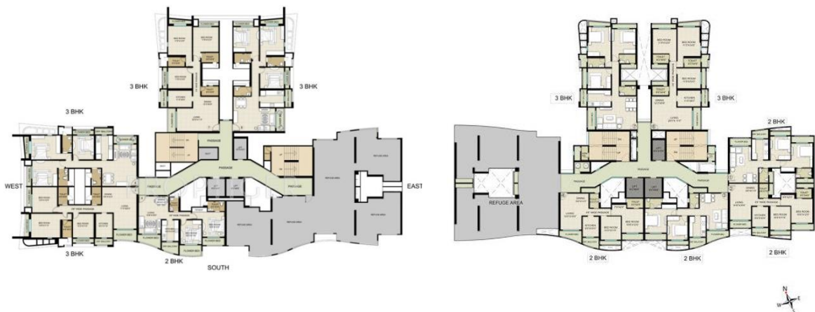
Hình 3-31: Mặt bằng tầng điển hình có bố trí gian lánh nạn cạnh nhau
