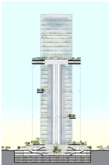
Hình 3-10: Mặt cắt phân đợt TLN kết hợp với vườn trên cao và dịch vụ công cộng
